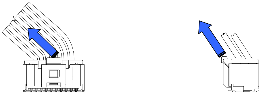
Fig.9-3-1 電線にたわみを持たせた状態
